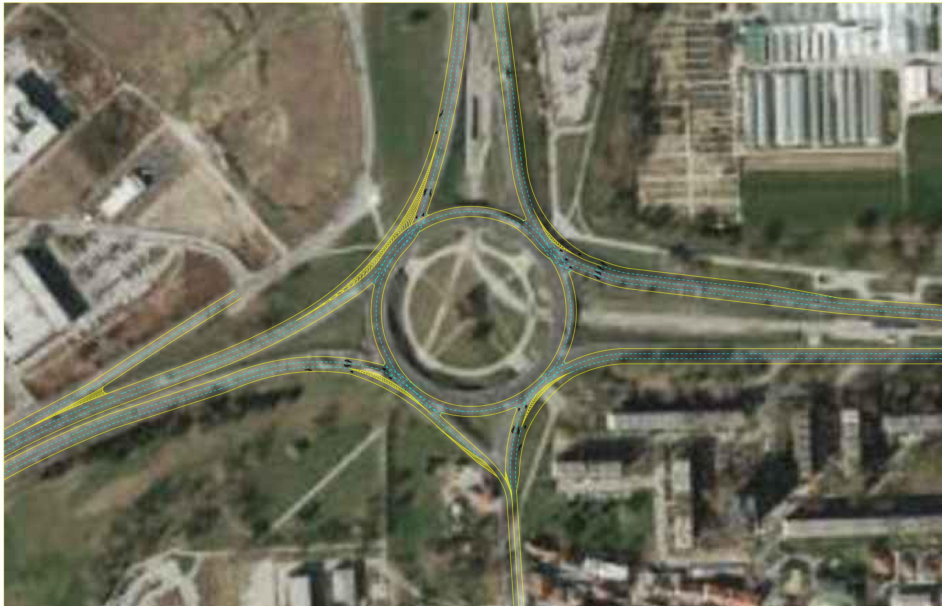
Slika 13.: Mikro prikaz turbo rotora sa izdvojenim trakama za desne skretače (izradila autorica)
