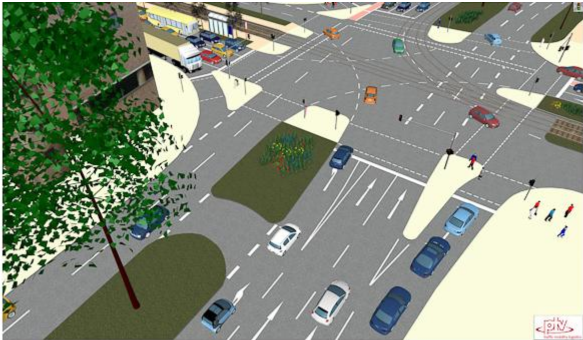
Slika 5. VISSIM 3D simulacija iz ptičje perspektive
