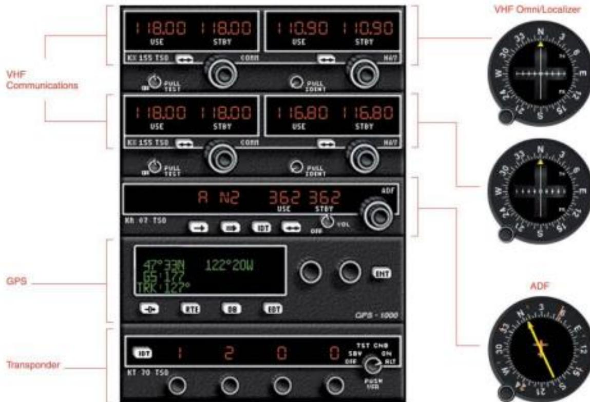
Slika 14. Prikaz kontrolne ploče u suvremenom zrakoplovu
