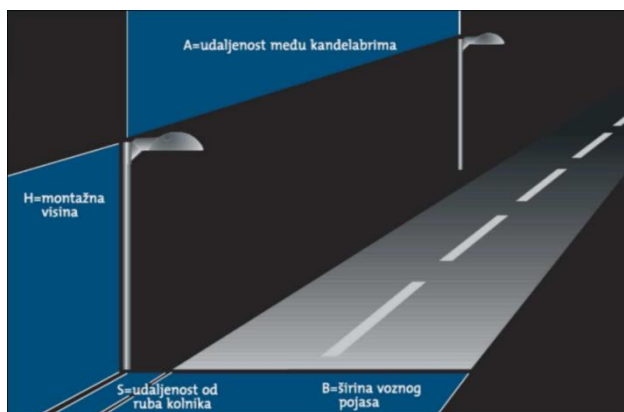
Slika 8. Geometrija postavljanja svjetiljki, [10]
