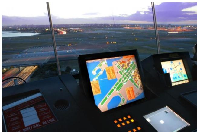
Slika 2 Zaslon *Surface Movement Radar-a*
