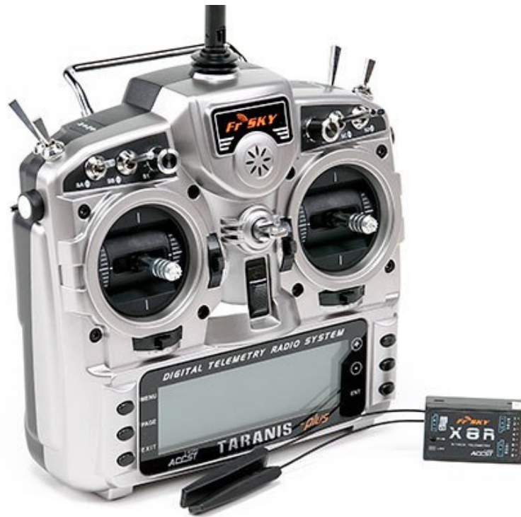
Slika 22. Radio-komunikacijski sustav: radio stanica i prijamnik, [26]
