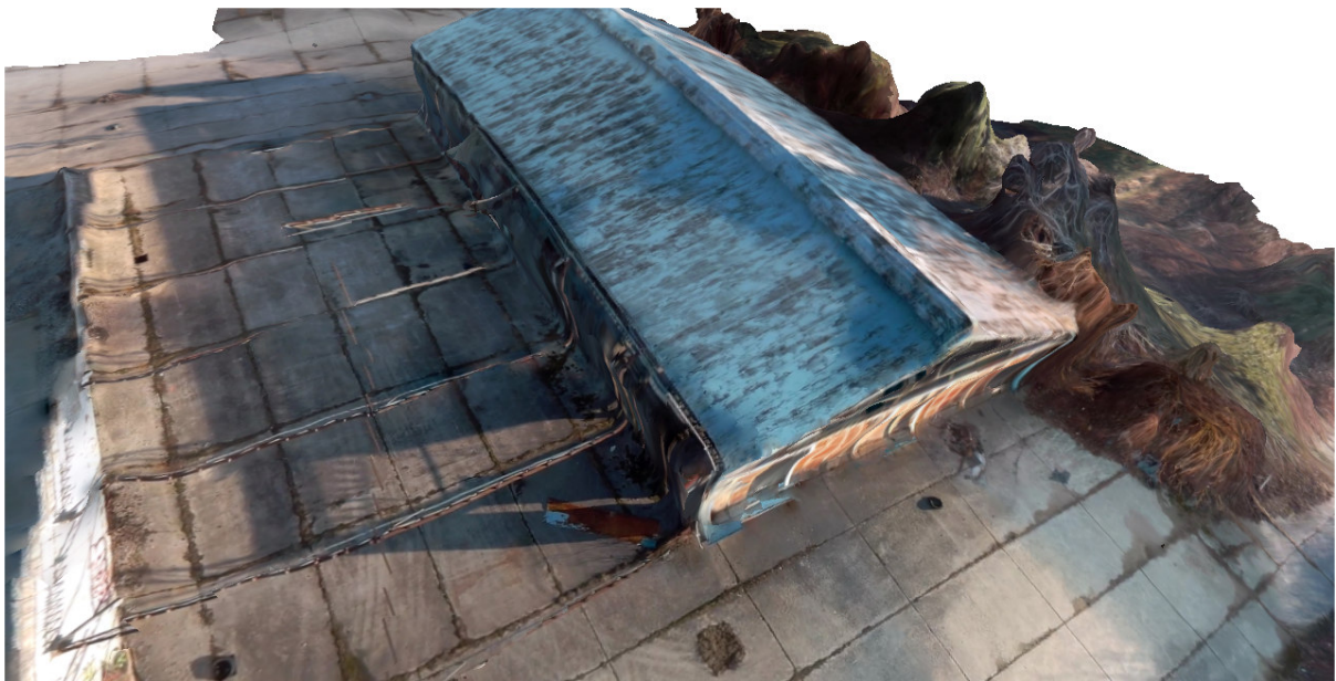
Slika 57. DEM trokutna mreža s dodanom teksturom, na osnovu snimka iz zraka
