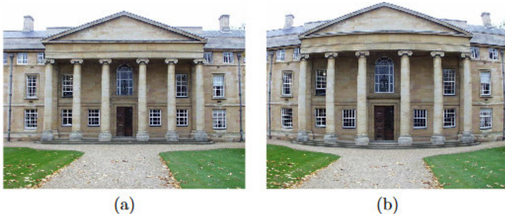
Slika 25. Radijalna distorzija. (a) Slika bez distorzije. (b) Slika s radijalnom distorzijom, točke su radijalno pomaknute od centra slike, [26]
