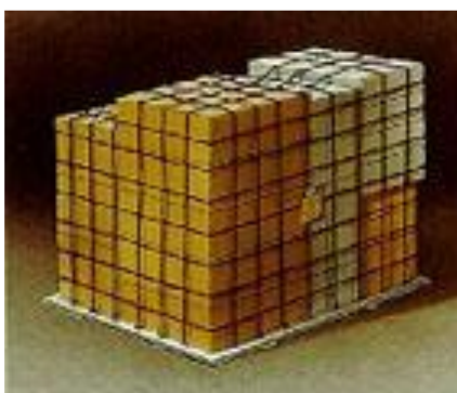
Slika 3. Paleta PMC (izmjere: 205 x 300 cm, volumen: 10,6 m 3 , max. neto težinski kapacitet: 11 835 kg) [21]
