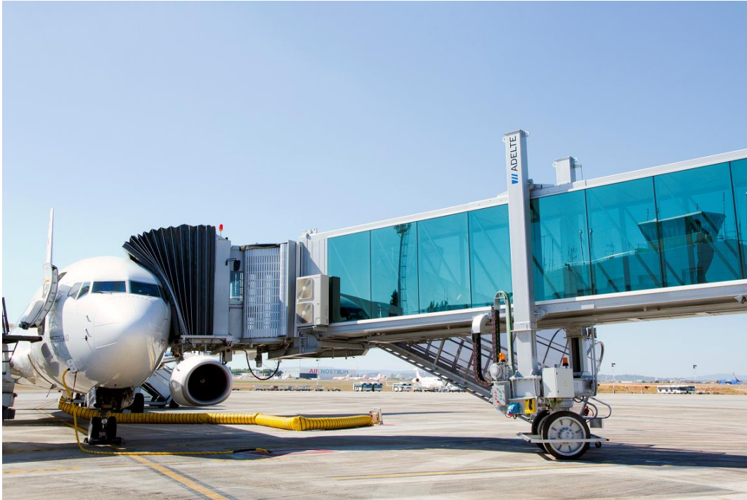
Slika 4.18. Prihvat i otprema aviona sa aviomostom, [15]
