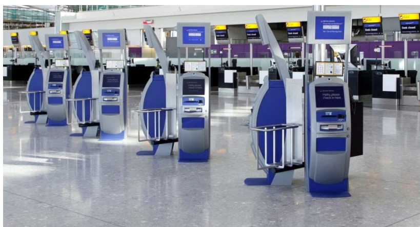
Slika 4.13. Sustav registracije putnika putem samouslužnih kioska bez prtljage u međunarodnoj zračnoj luci Heathrow Terminala 5, [11]
