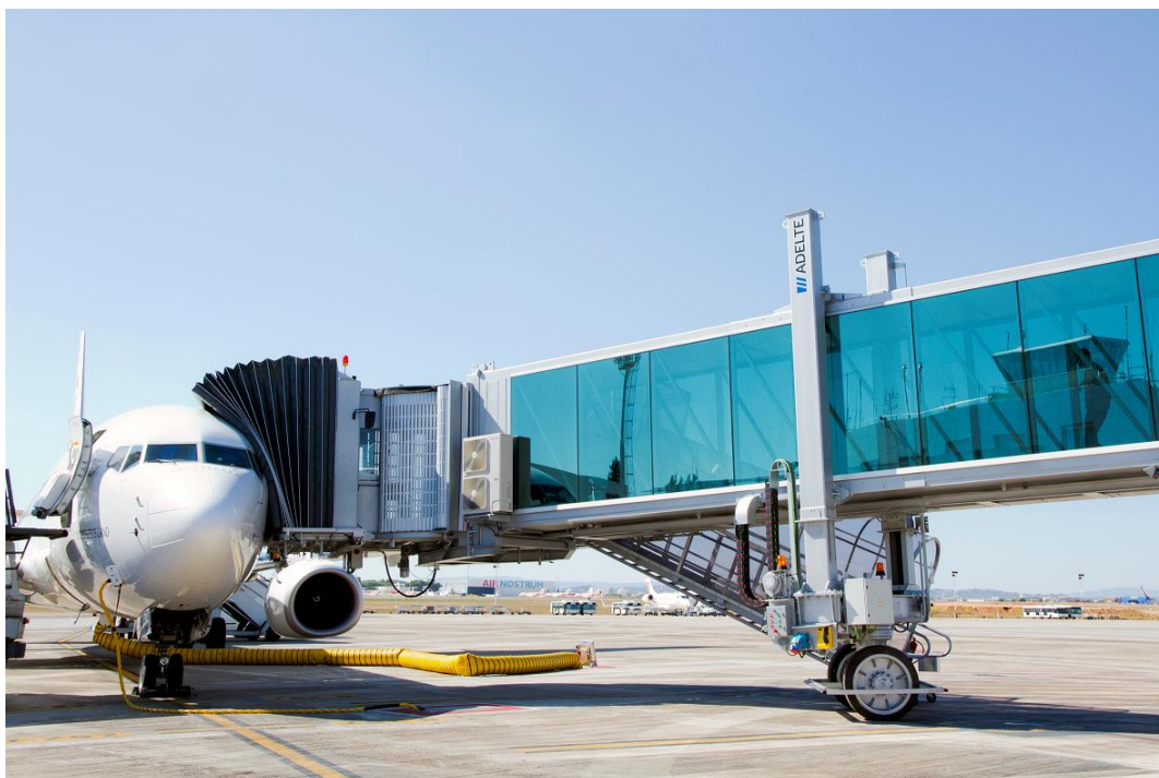
Slika 4.18. Prihvat i otprema aviona sa aviomostom, [15]
