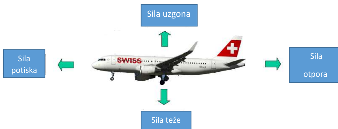
Slika 2.1. Sile koje djeluju na zrakoplov u letu
