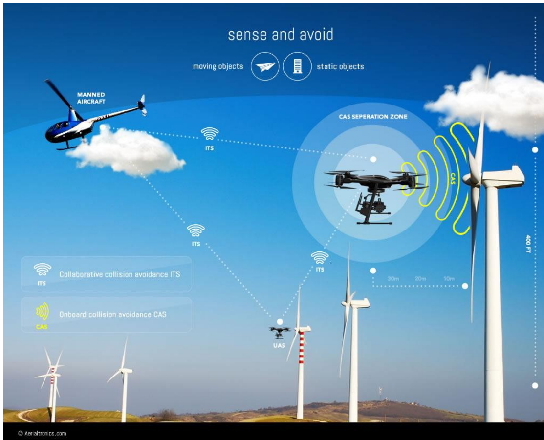
Slika 13. Princip rada „Osjeti i izbjegni“ sustava, [25]
