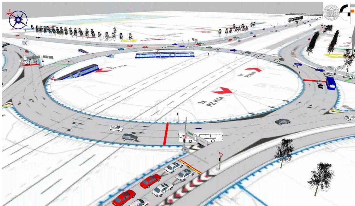
Slika 7: Prijedlog rješenja rekonstrukcije raskrižja Avenija Dubrovnik – Rotor
