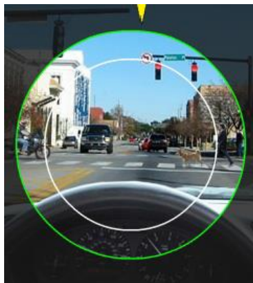
Slika 33. Prostor jasnog vidnog polja vozača kod brzine kretanja veće od 60 km/h [1]
