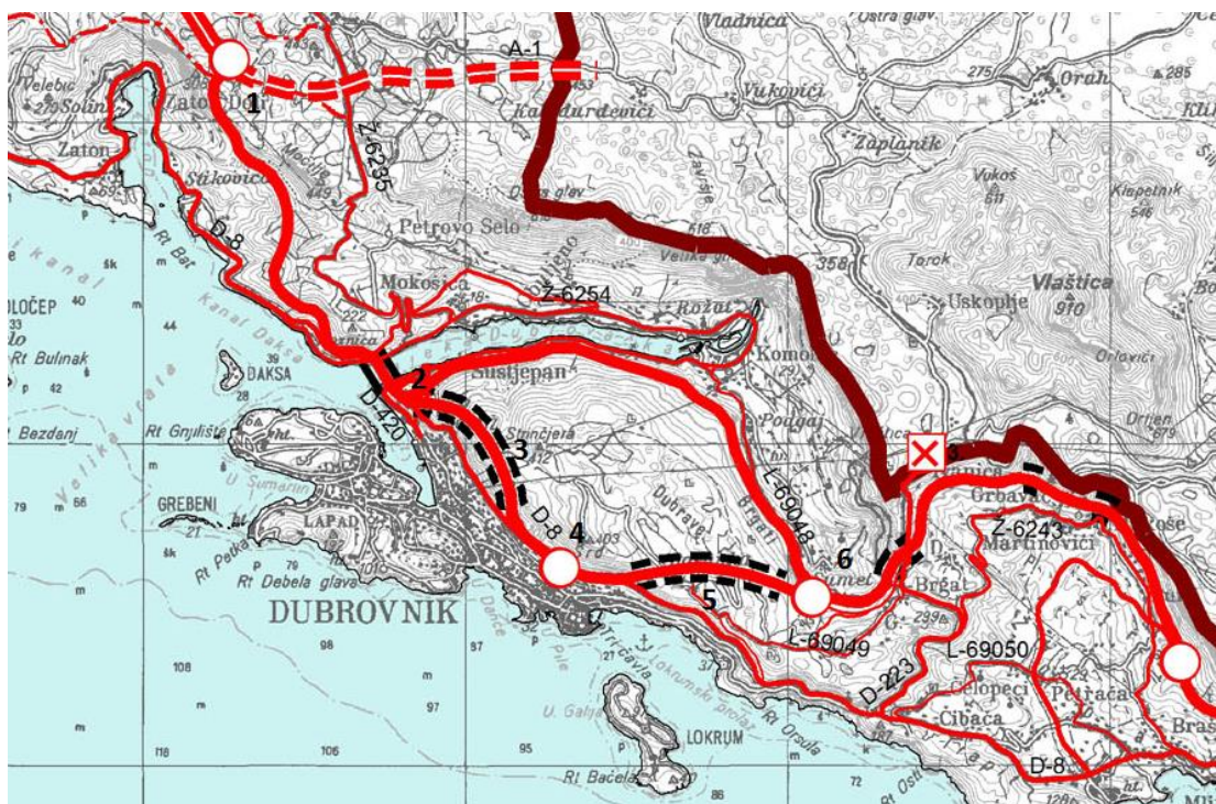
Slika 11: Varijanta 1 brze ceste Dubrovnik – Debeli brijeg, čvor Osojnik (1), čvor Dubrovnik – zapad (2), tunel Nuncijata (3), čvor Ilijina glavica (4), tunel Srđ (5), čvor Dubrovnik istok (6) Izvor: Izmjene i dopune prostornog plana Dubrovačko – neretvanske županije 2013.
