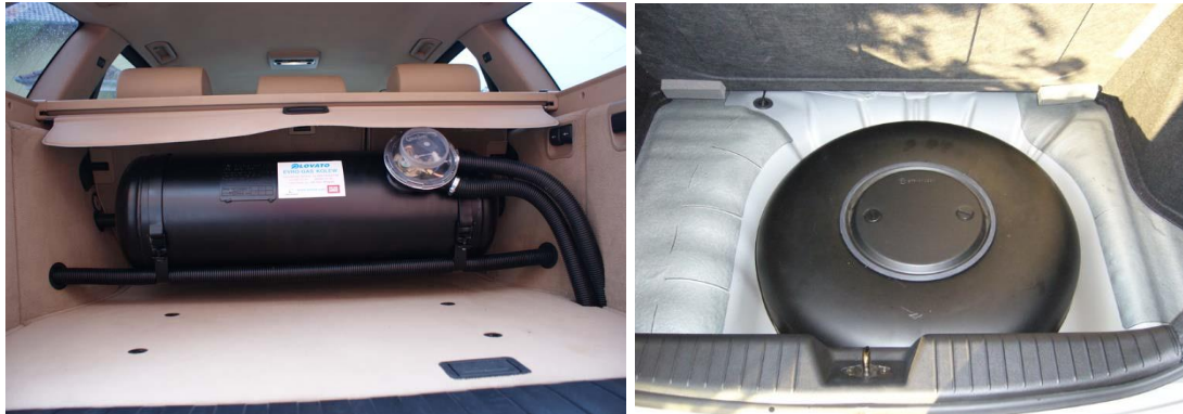
Slika 7. Spremnici za autoplin
