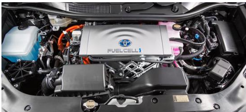
Slika 9. Spremnika gorivih ćelija na motoru Toyote Mirai
