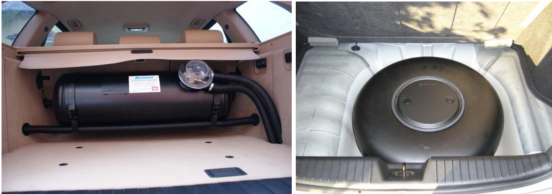
Slika 7. Spremnici za autoplin
