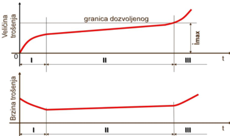
Slika 3.11. Prikaz ovisnosti veličine trošenja o vremenu i krivulja brzine trošenja, [3]
