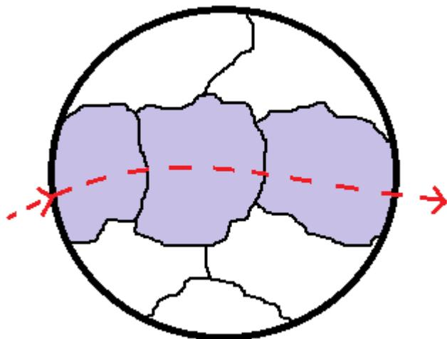
Slika 3.1. Transkristalni prijelom zbog zamora, [4]
