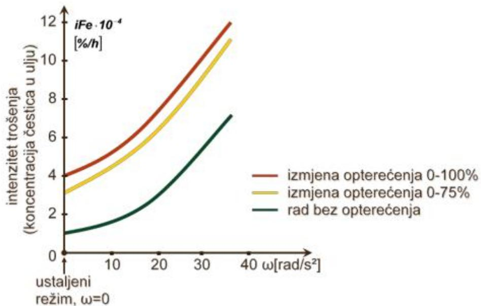
Slika 4.1. Intenzitet trošenja cilindra u funkciji ubrzanja radilice i opterećenja motora,
