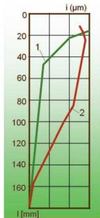
Slika 5.3. Utjecaj radne temperature motora na intenzitet trošenja, [3]
