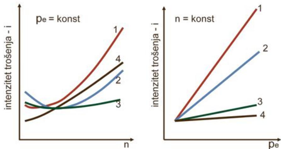
1. istrošenje cilindra, 2. klipnih prstenova
