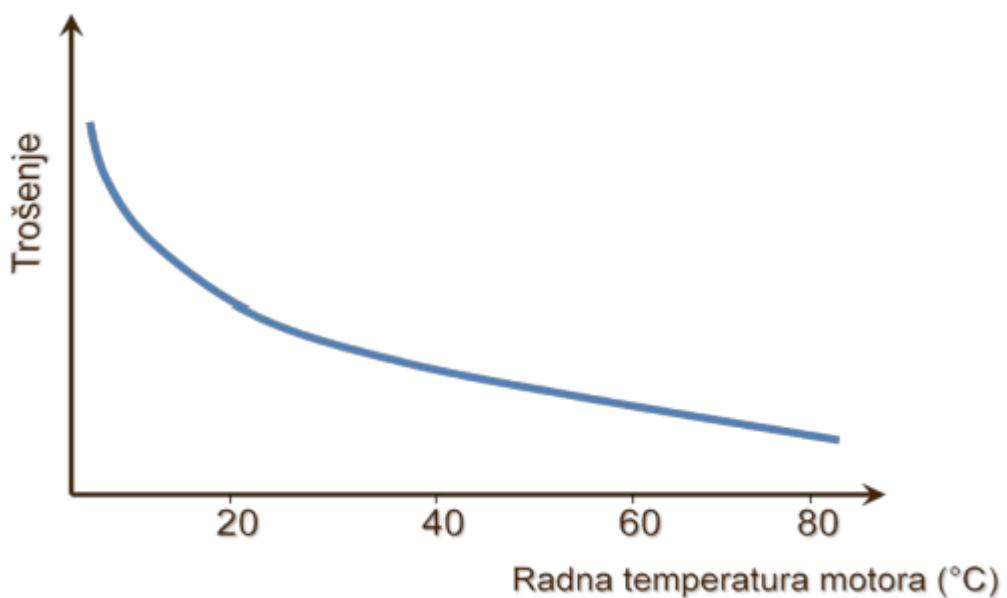
Slika 5.2. Ovisnost trošenja o radnoj temperaturi motora, [3]
