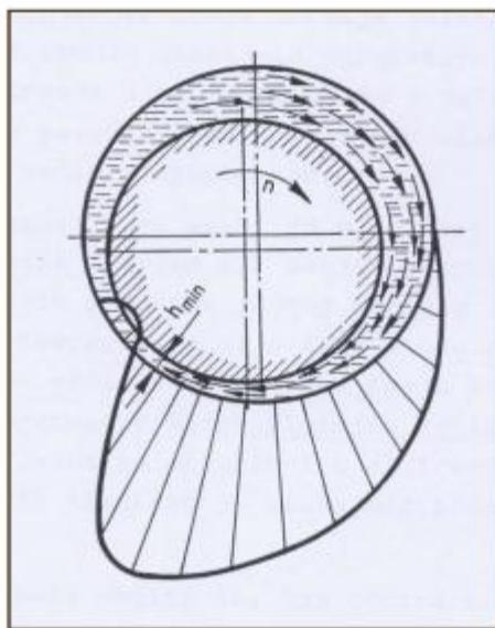
Slika 3.9. Shema stvaranja uljnog sloja klizni ležaj-vratilo, [3]
