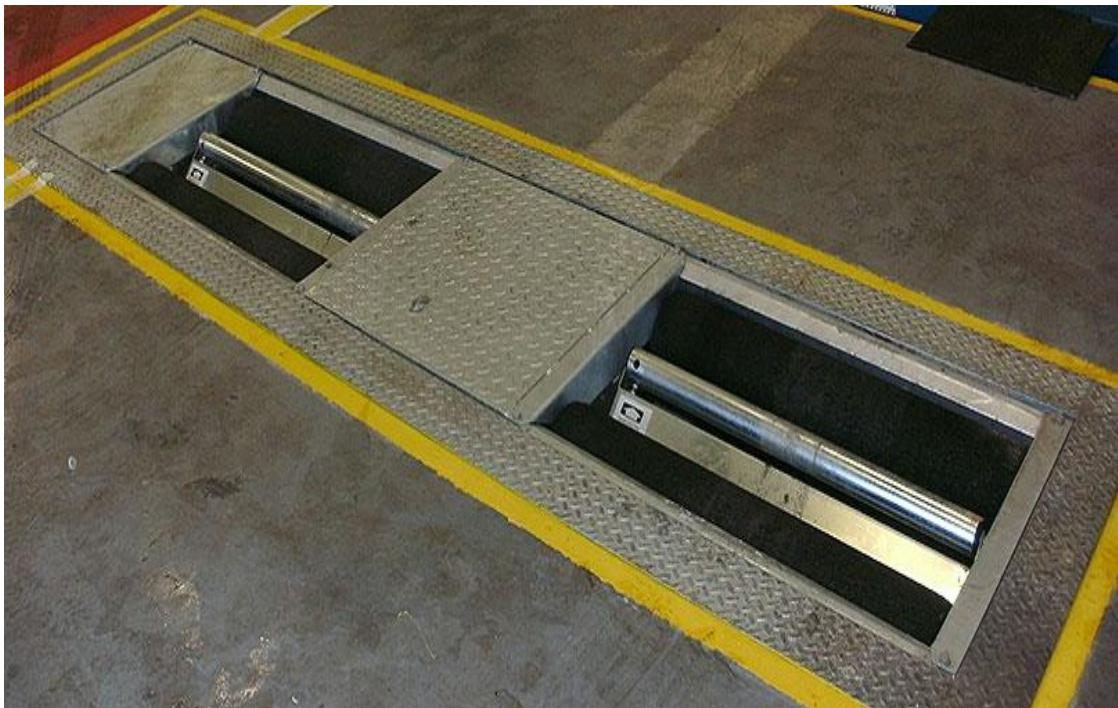
**Slika 4.** Valjci za testiranje kočionog sustava, [10].
