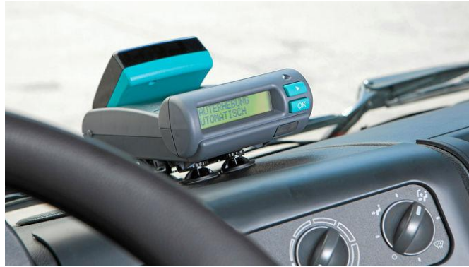
Slika 3.1. OBU – On Board Units [12]
