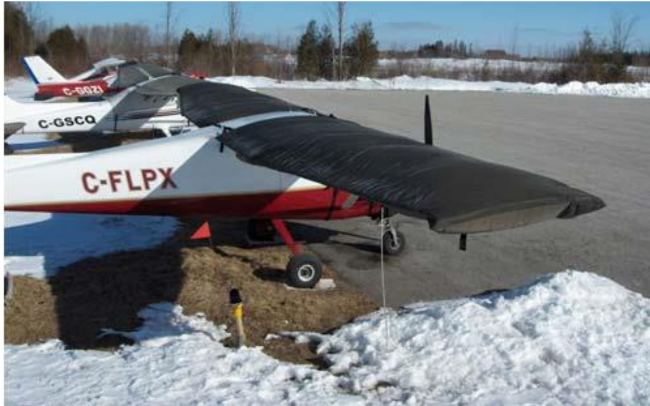
Slika 5. Navlaka protiv smrzavanja krila zrakoplova
