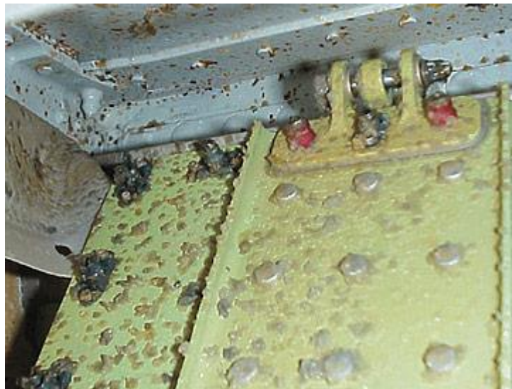
Slika 13. Zgusnuta nakupina tekućine za zaštitu zrakoplova od zaleđivanja
