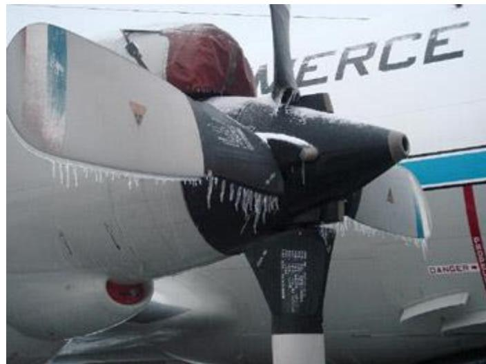
*Slika 3. Zamrznuti propeler motora zrakoplova*
