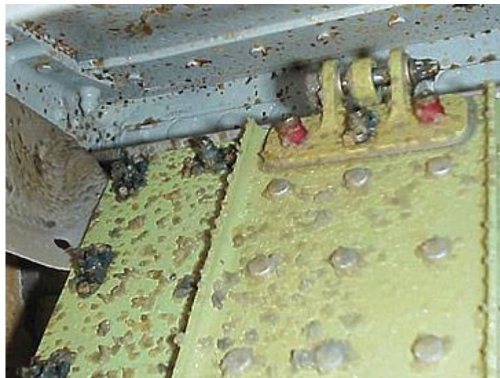
Slika 13. Zgusnuta nakupina tekućine za zaštitu zrakoplova od zaledivanja
