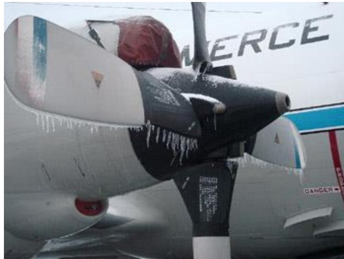
Slika 3. Zamrznuti propeler motora zrakoplova
