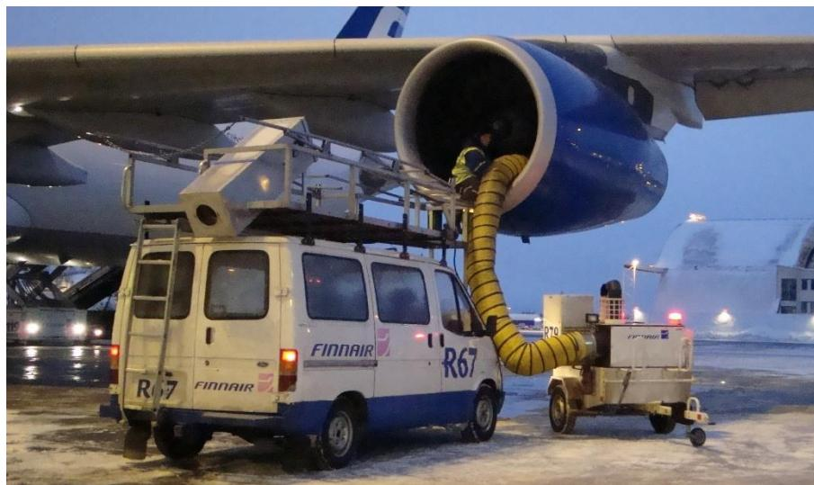
Slika 12. Odleđivanje lopatica kompresora motora vrućim zrakom
