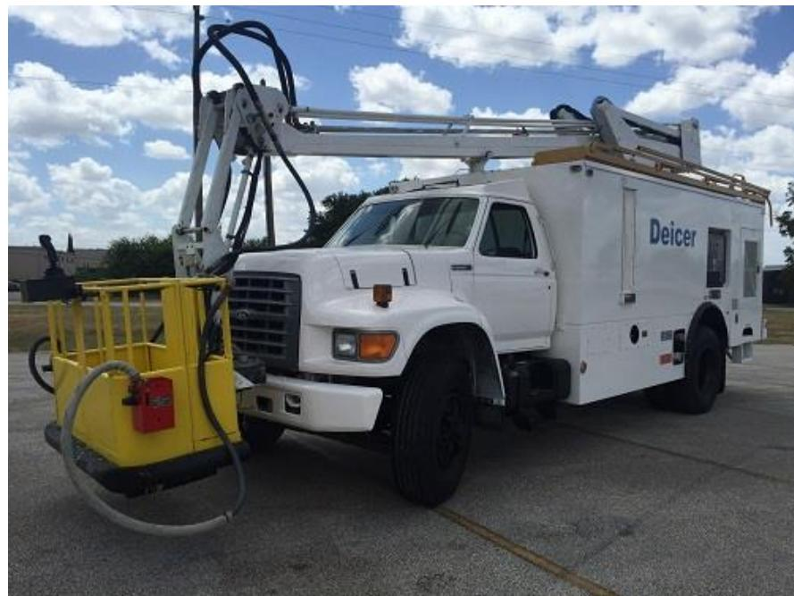
*Slika 15. Vozilo za odleđivanje i zaštitu zrakoplova od zaledivanja*
