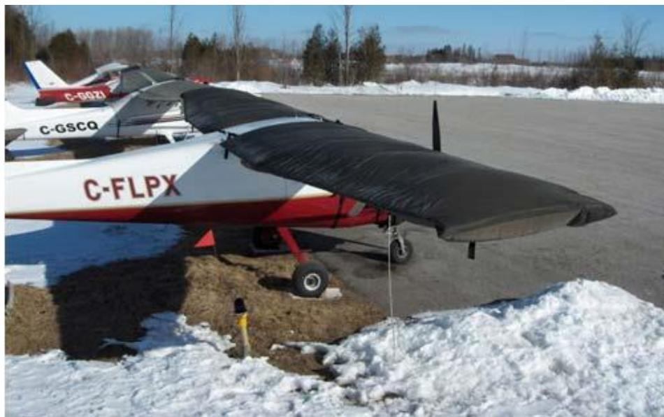
*Slika 5. Navlaka protiv smrzavanja krila zrakoplova*
