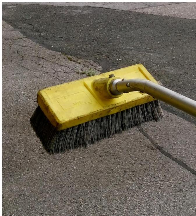
Slika 4. Metla za ručno čišćenje kontaminanta sa zrakoplova
