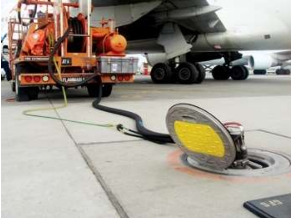
Slika 6.-Prikaz opskrbe a/c-a gorivom putem samohodne pumpe
