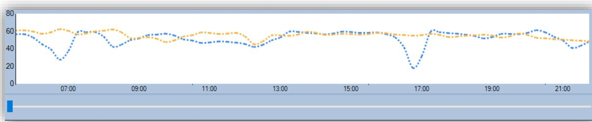
**Slika 5.** Grafikon dvosmjernih profila brzina sa jasno prikazanim vremenima zagušenja unutar aplikacije *SegCalc*
