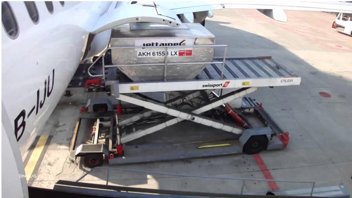
Slika 2.3. Iskrcaj tereta iz zrakoplova pomoću teretnog utovarivača
