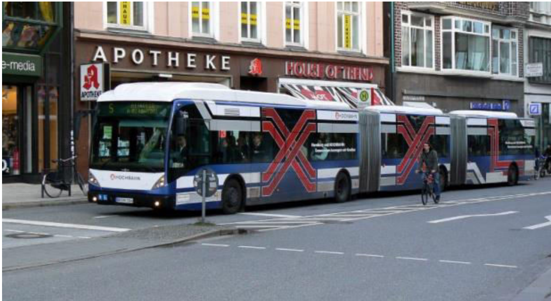
Slika 8. Četveroosovinski autobus sa trodijelnom karoserijom u Hamburgu
