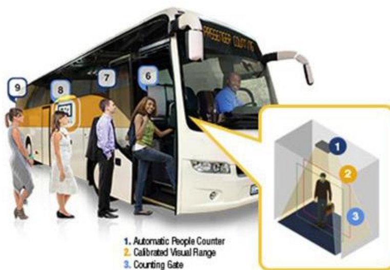
Slika 1. Automatski brojač putnika koji očitava polje preglednosti
