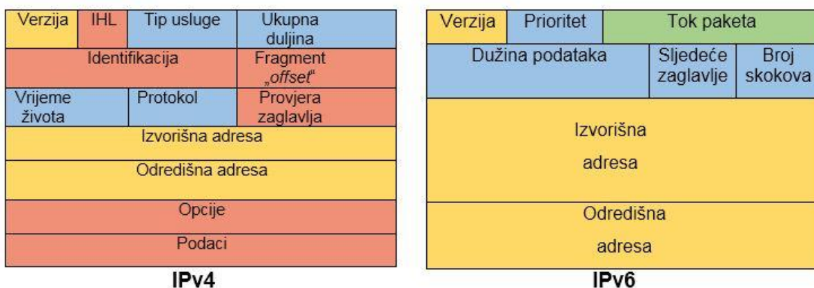
Slika 3: Usporedba IP zaglavlja različitih verzija protokola, [5]
