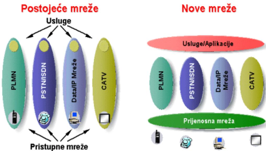
**Slika 6.** Prikaz vertikalno i horizontalno ustrojenih mreža, [15]
