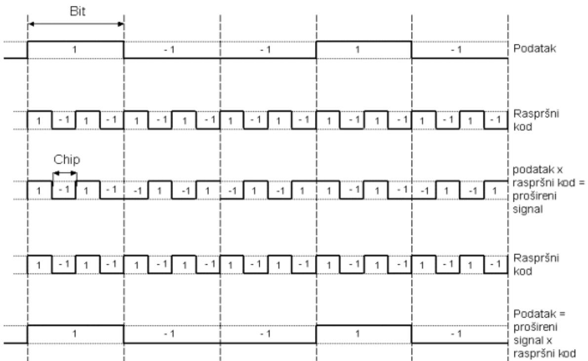
**Slika 10.** Proširenje signala korištenjem raspršnog koda, [15]
