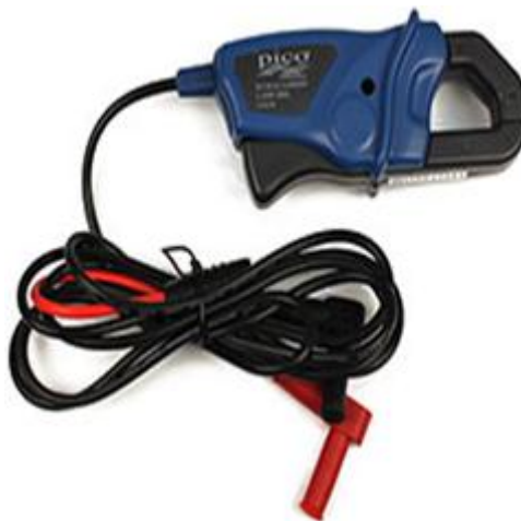
Slika 15. Stežaljka za mjerenje jakosti struje od 0 - 600 A [7]
