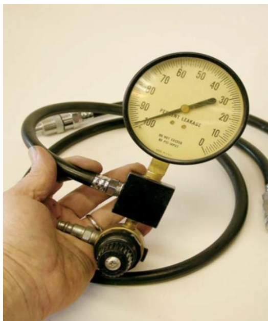
Slika 12. Instrument za mjerenje kompresije komprimiranog zraka s jednim manometrom [2]
