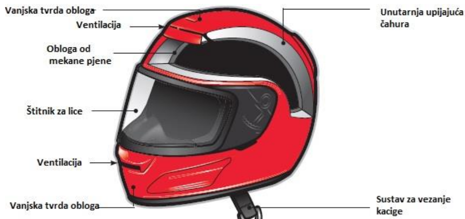
Slika 15: Djelomični presjek kacige
