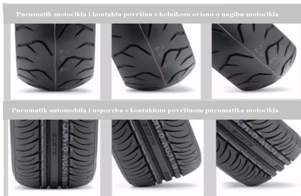
Slika 3: Svojstva i usporedba pneumatika motocikla i automobila
