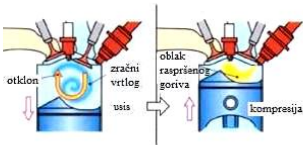
Slika 24. Ubrizgavanje kod djelomičnog opterećenja[1]
