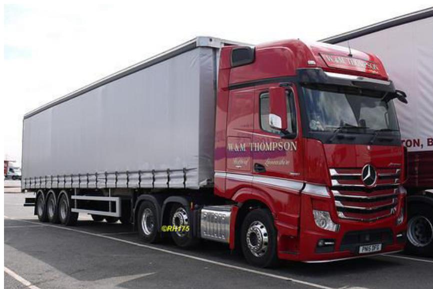
Slika 8. Tegljač s tri osovine i poluprikolica s tri osovine
