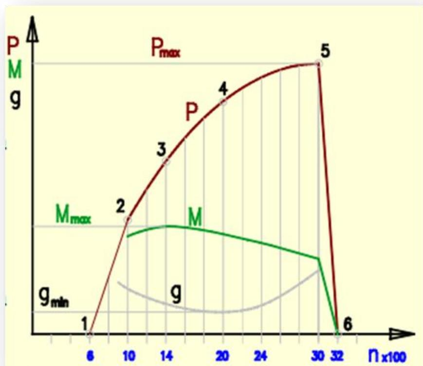
Slika 2: Vanjska brzinska karakteristika
