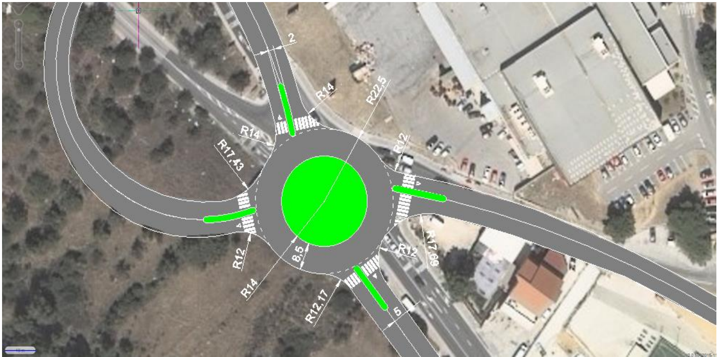
Slika 16. Izgled raskrižja nakon izgradnje kružnog toka
