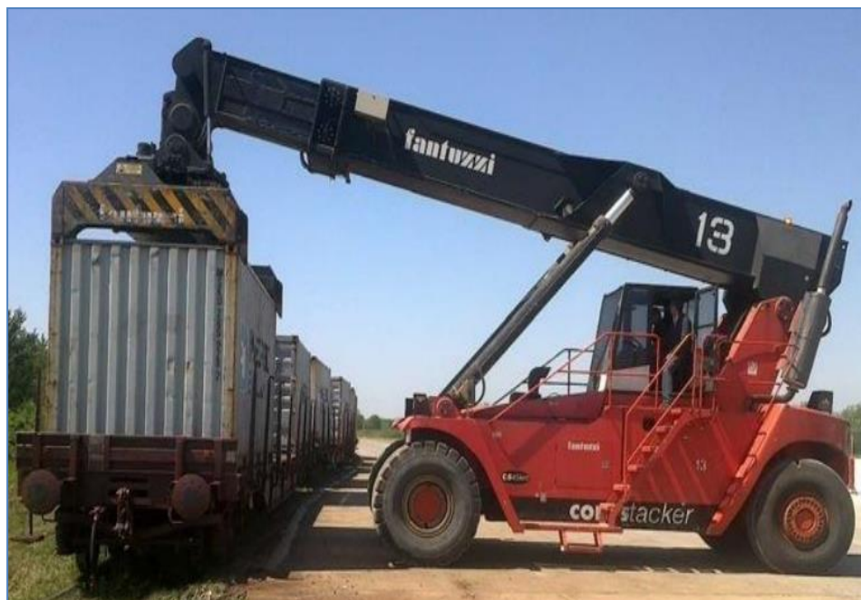
Slika 16. Prikaz ukrcanja kontejnera na vagon
