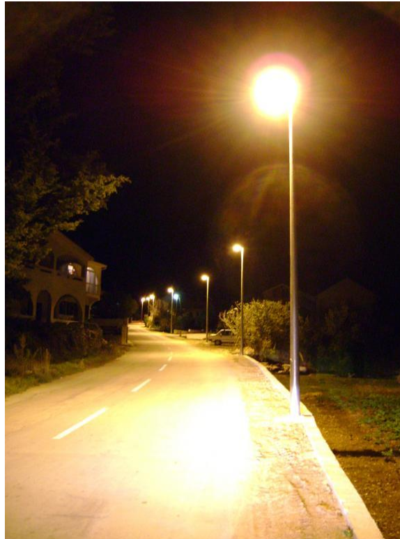
Slika 9. Jednostrani raspored izvora svjetlosti
