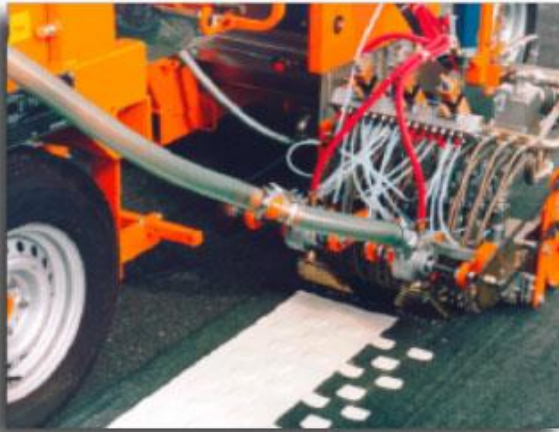
Slika 17. Prikaz stroja za nanošenje termoplastike-Extruder
