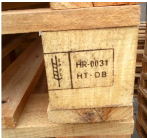
Slika 9: Oznaka termički obrađene palete
