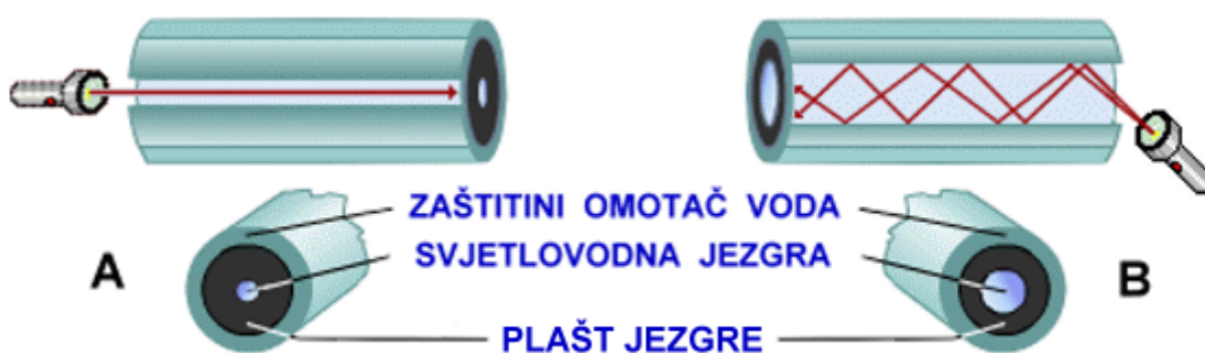
Slika 5. Optičko jednomodno i višemodno vlakno
