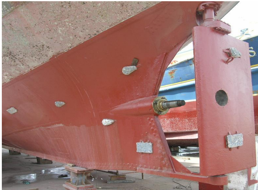
Slika 5. Žrtvujuće anode na području propelera
