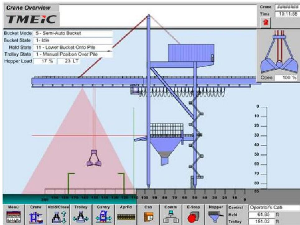
**Slika 29.** Ekran sustava za praćenje rada dizalice
