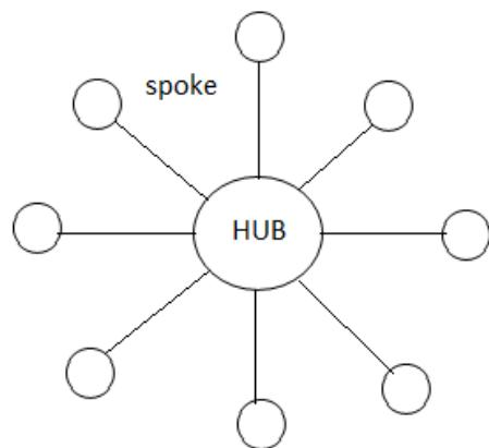
**Slika 5.** Shematski prikaz „hub and spoke“ terminala
