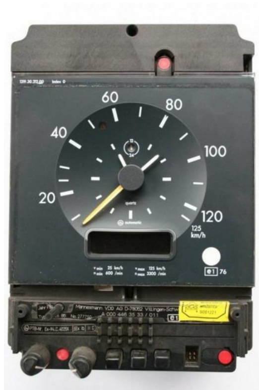
Slika 5. Primjer analognog tahografa novije generacije (samo za MB vozila, bez pristupa pisačima)
