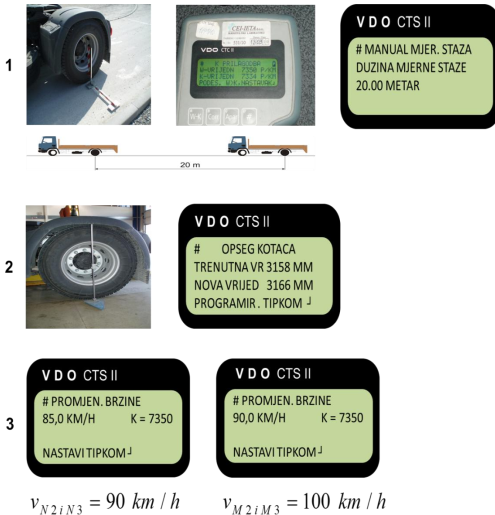
Slika 18. Osnovno ispitivanje i kalibracija tahografskog uređaja
