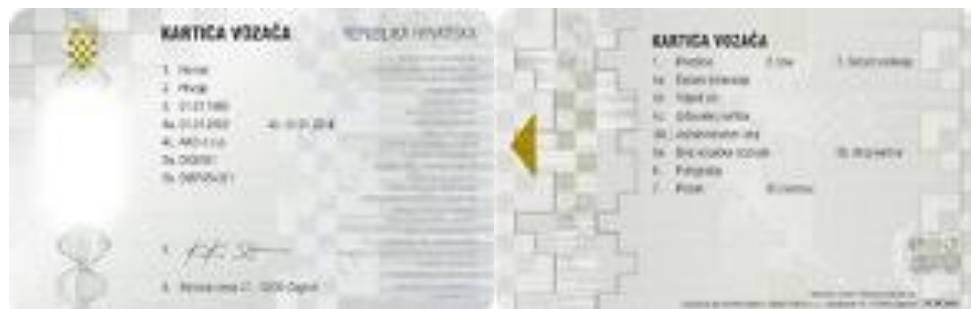
Slika 10. Prednja i stražnja strana kartice vozača – komponenta digitalnog tahografskog uređaja
