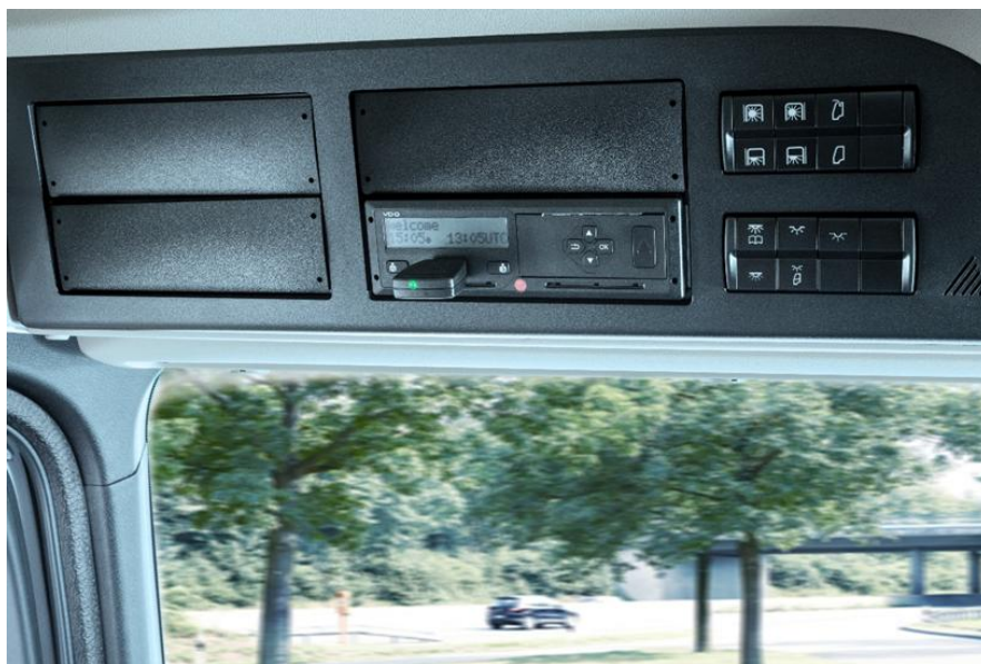
Slika 8. VDO Digitalni tahograf – uređaj u vozilu
