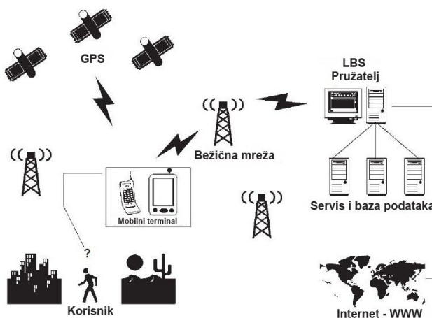
Slika 21. Opći prikaz arhitekture LBS-a, [8]
