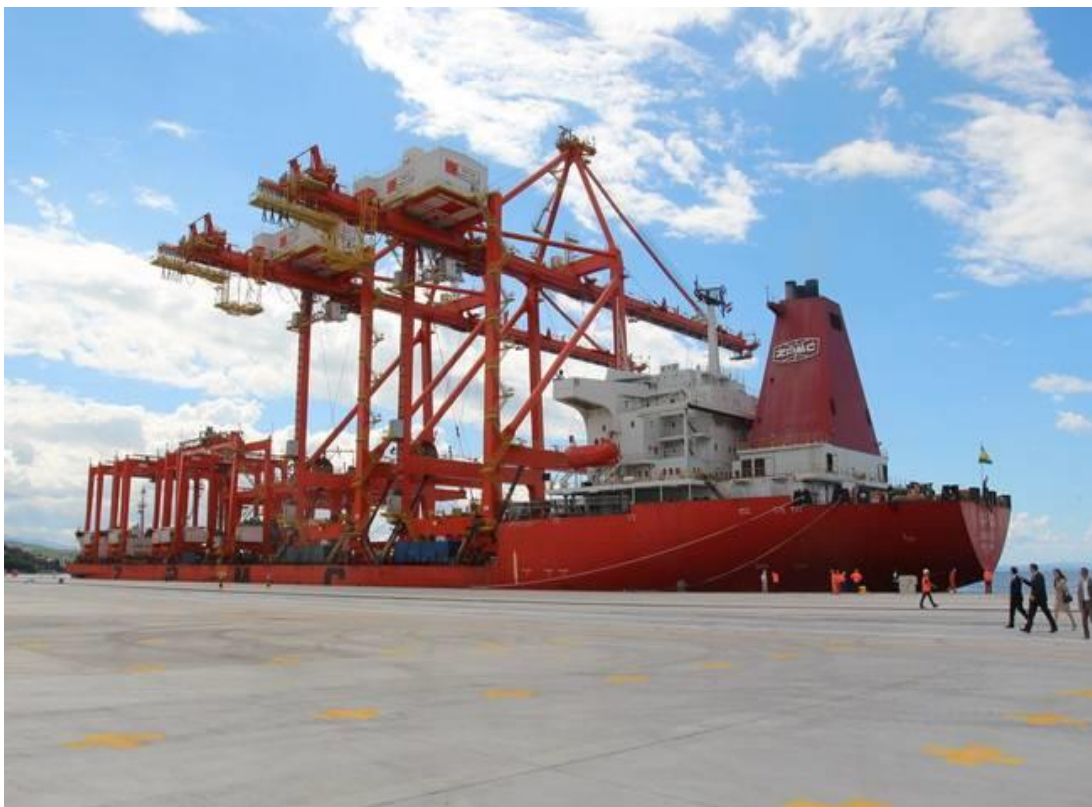
Slika 15. Panamax dizalica Izvor: http://www.rijeka.hr/ (rujan, 2015.)
