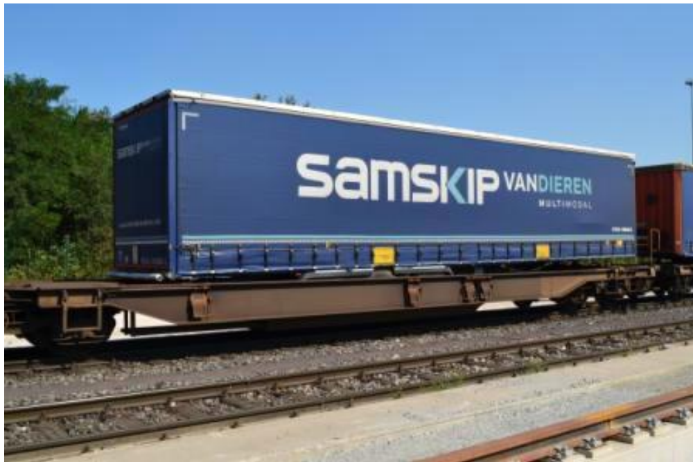
Slika 1. Prikaz huckepack tehnologije Izvor: http://baltictransportjournal.com/ (kolovoz, 2015)
