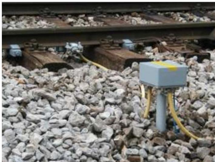
*Slika 5. Kontrolni elektronički sklop VUR vanjskog uređaja u kutiji uz kolosijek [6].*
