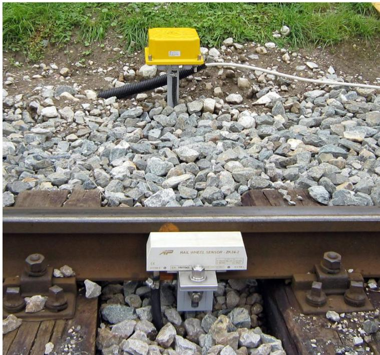
Slika 18. Senzor željezničkog kotača ZK24-2 (Altpro) [2].
