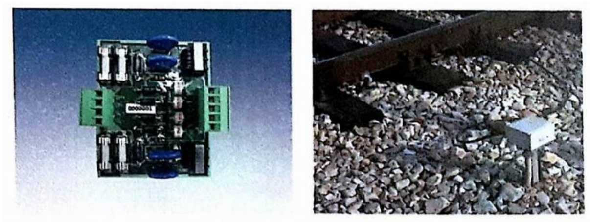
Slika 21. ZGK modul za zaštitu od grmljavine (Altpro) [6].
