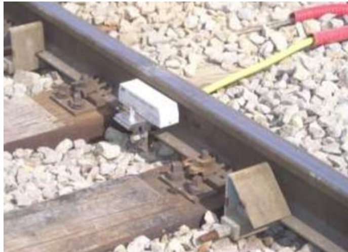
Slika 4. Senzor ZK24-2 na nosaču montiran uz tračnicu sa pripadajućim štitnicima [2].
