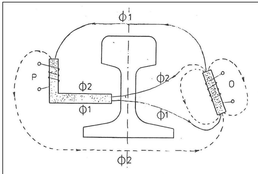
Slika 9: Princip rada senzora SK11 i SK30
