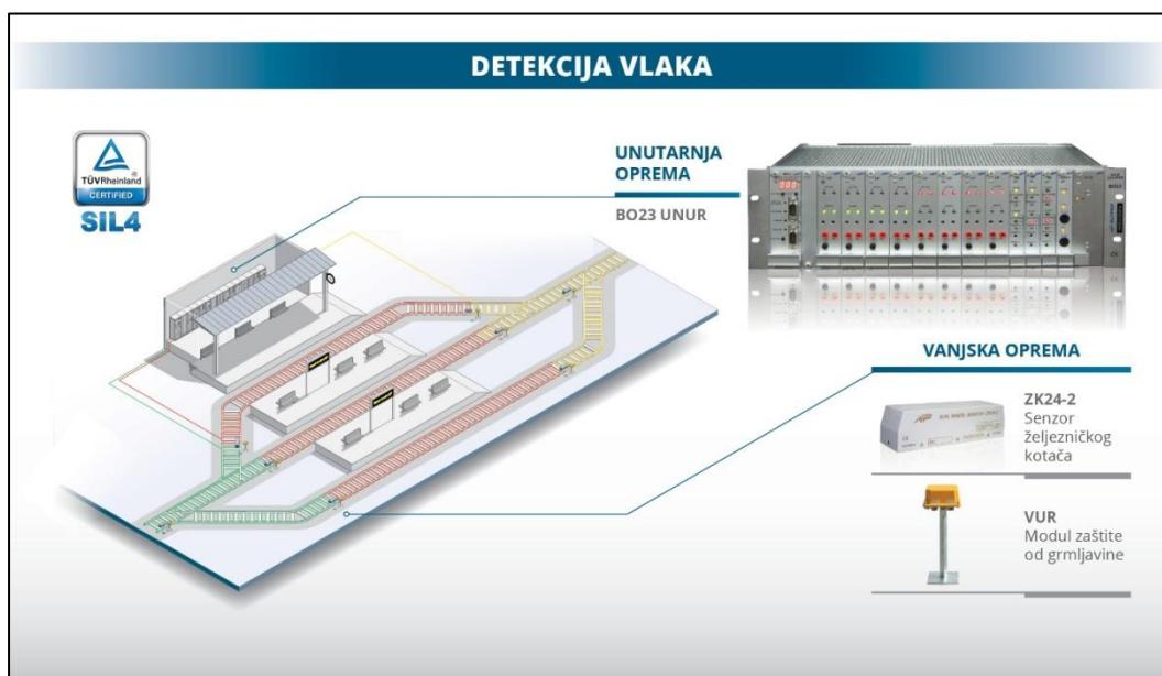
Slika 11: Prikaz brojača osovina sa pripadajućim sklopljivim
