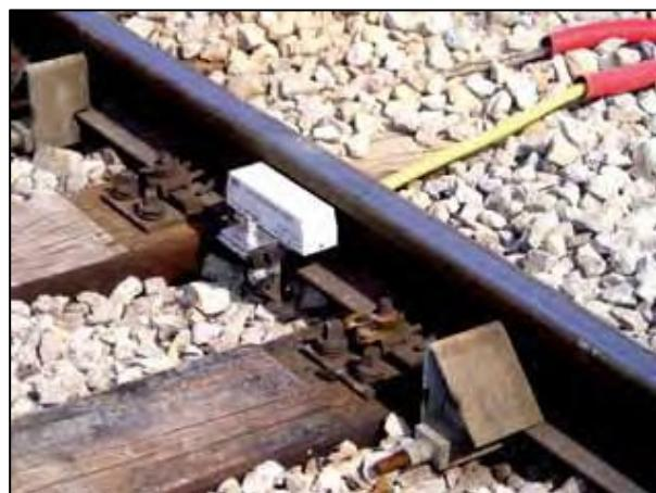
Slika 12: Prikaz senzora željezničkog kotača ZK24-2
