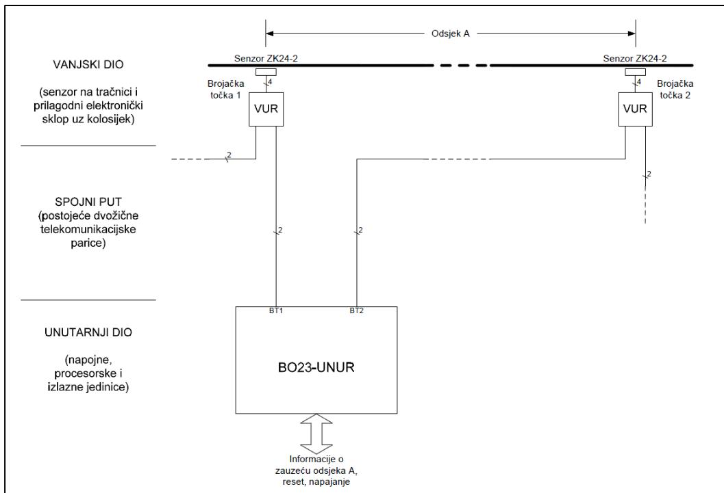
Slika 8: Principijelna shema modernog brojača osovina proizvođača Altpro
