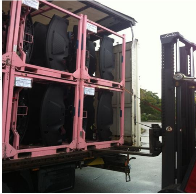
Slika 16: Prikaz utovara paleta u kamion viličarom
