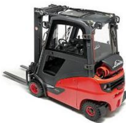
Slika 11: Plinski čeonu Linde viličar
