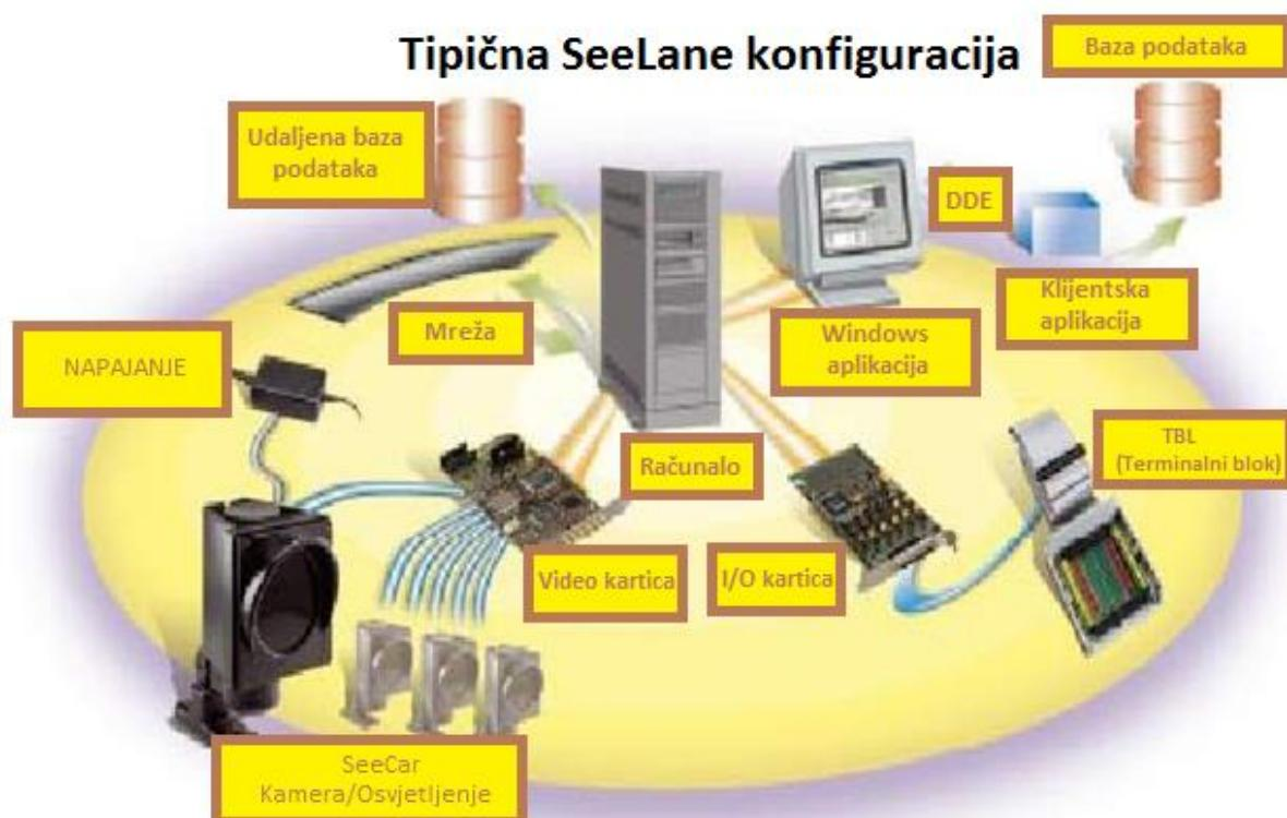
Slika 14. Tipična konfiguracija ALPR sustava [10]
