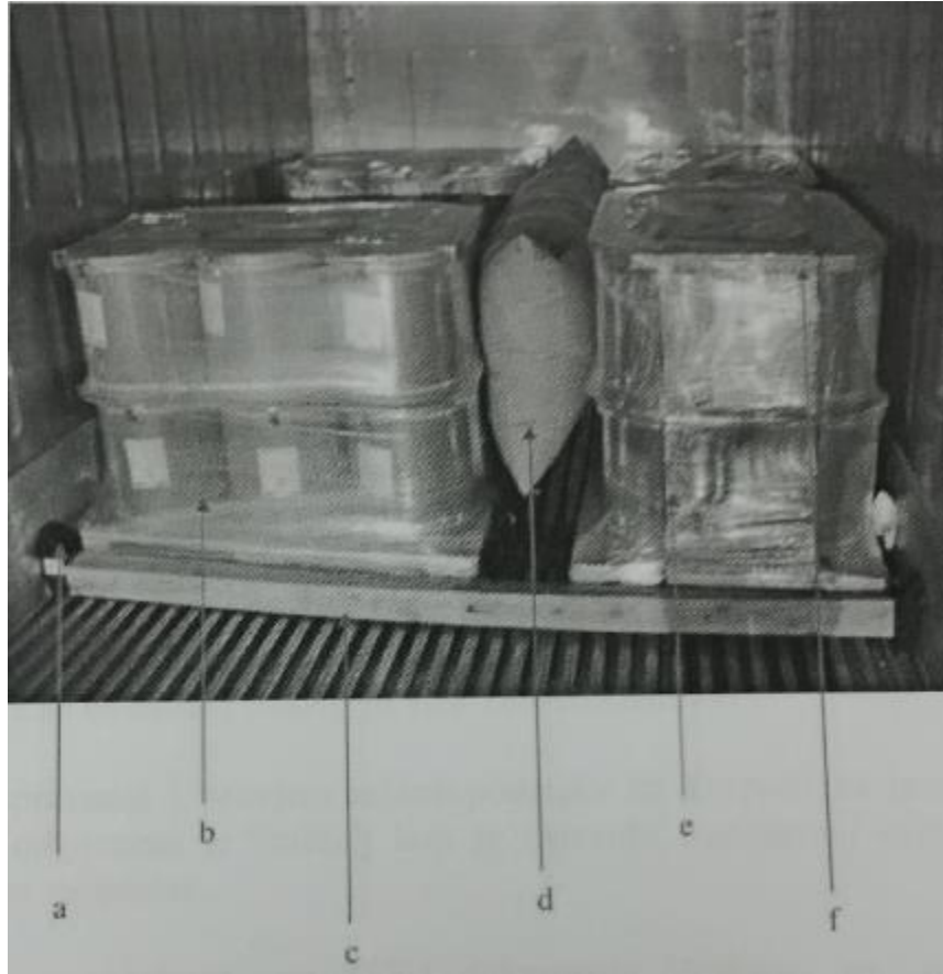
Slika 22. Način slaganja paletnih jedinica u prijevozno sredstvo
