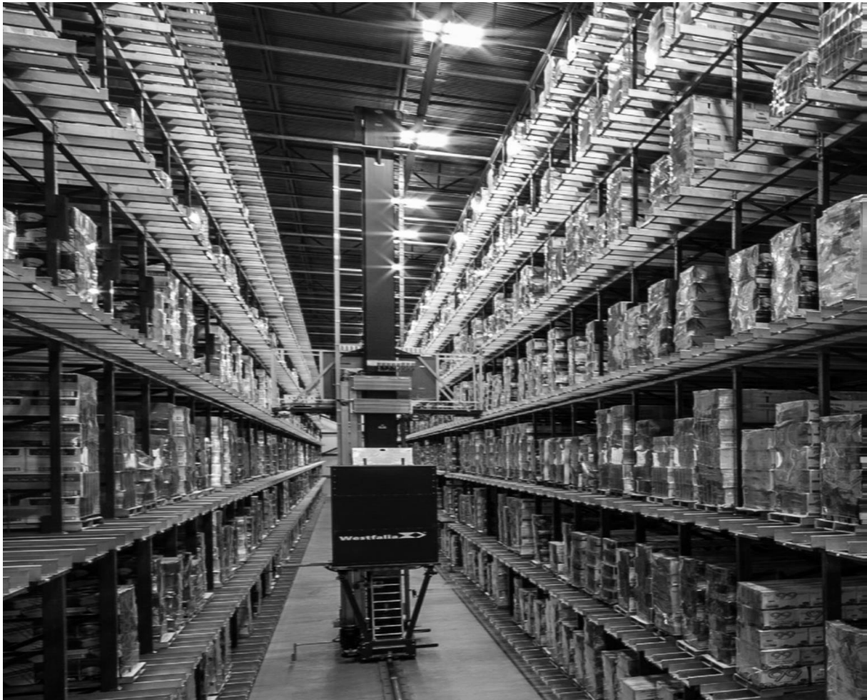
Slika 24.: Automatizirana visokoregalna dizalica u Glenmore destileriji Izvor: [11]
