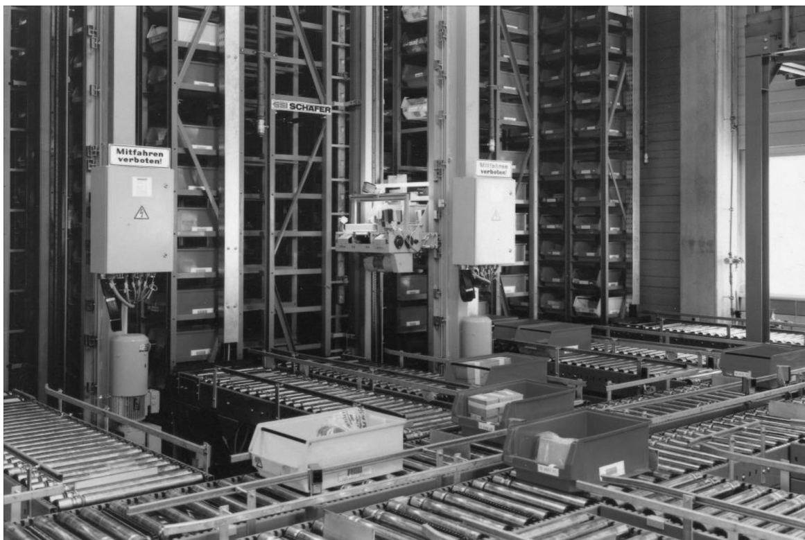
Slika 18.: Mini load AS/RS sustav Izvor: [7]
