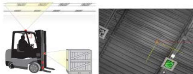
**Slika 11:** Optičko očitavanje barkod oznaka na paletama i na stropu skladišta u svrhu lociranja paleta i viličara
