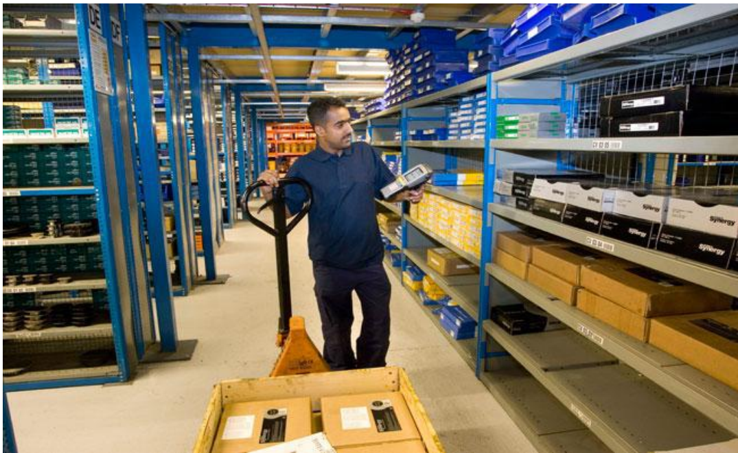
Slika 15. Komisioniranje uz pomoć bar kod čitača Izvor: [21]
