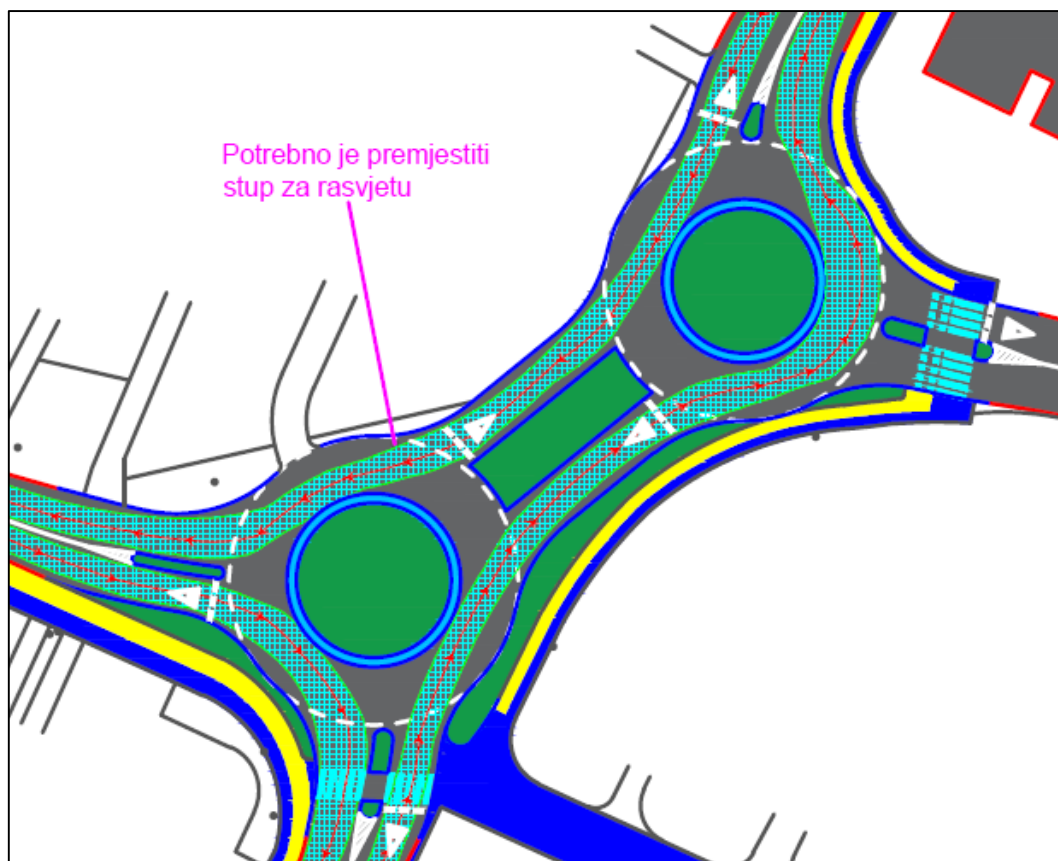
Slika 5.6. Pregled pojedinih trajektorija mjerodavnog vozila Varijante 1 Legenda: svjetloplavi kvadratići – trajektorija mjerodavnog vozila; žuto osjenčano – biciklistička staza; plavo osjenčano – pješački nogostup; svjetloplavo osjenčano – povozna površina; zeleno osjenčano – nepovozna površina
